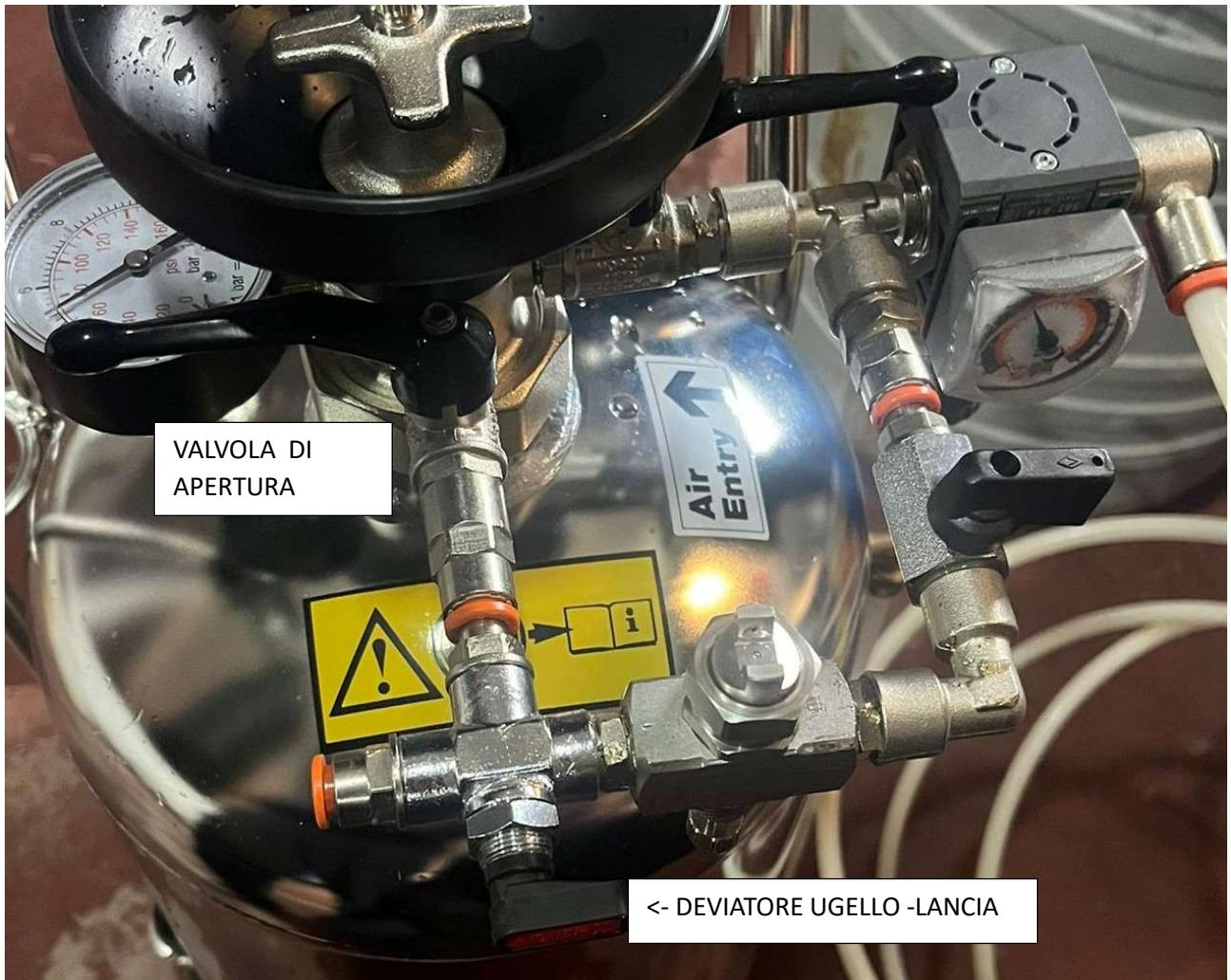
I 2 INNESTI AD ATTACCO RAPIDO VANNO ATTACCATI IN PARALLELO SIMULTANEAMENTE
